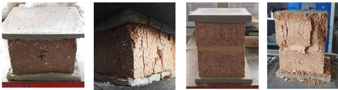
FIGURE 2. exemples d'éprouvettes destinées aux essais de caractérisation mécanique à haute température. De gauche à droite : demi-brique avant essai, demi-brique après essai à 300 °C, doublet avant essai, doublet après essai à 300 °C
