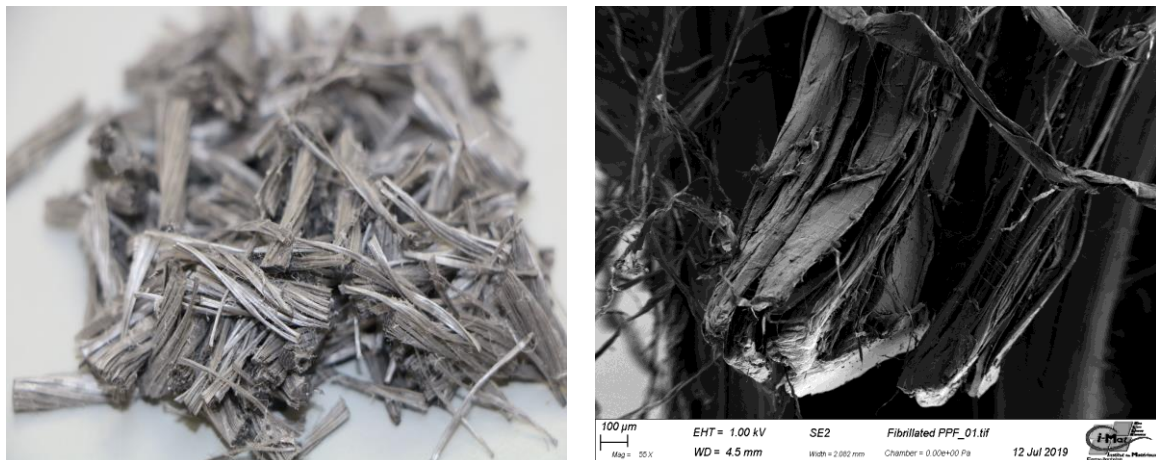
Figure 1. Image de la fibre utilisée en échelle normale et par MEB.
