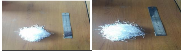
FIGURE 1. Les fibres polypropylènes utilisées L_1=2\text{cm} et L_2=3\text{cm}
