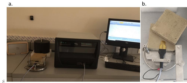
FIGURE 2. Méthode Hot Disk TPS : (a) setup (b) sonde de mesure
