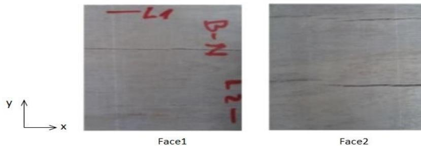
**FIGURE 1.** État du CP du Bété après séchage dans les conditions atmosphériques [10]
