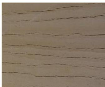
**FIGURE 8.** CP du Dabéma issu du séchage sous vide à 65°
