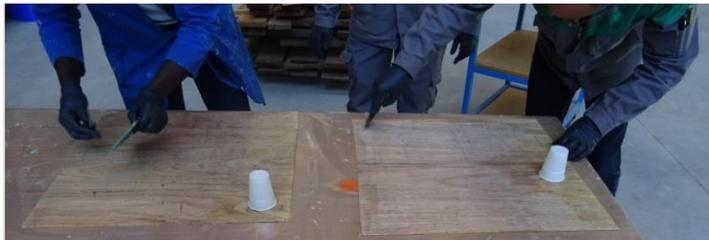
FIGURE 4. Préparation des contreplaqués : encollage des plis [10]
