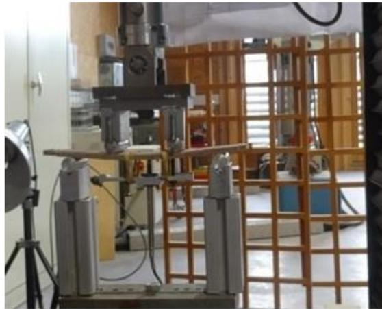
FIGURE 6. Banc d'essai de flexion 4 points
