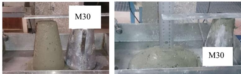
**Figure 3.** Affaissement au cône MBE. Affaissement à ( $t = 0$ ) Affaissement à ( $t = 2 \text{ s}$ )
