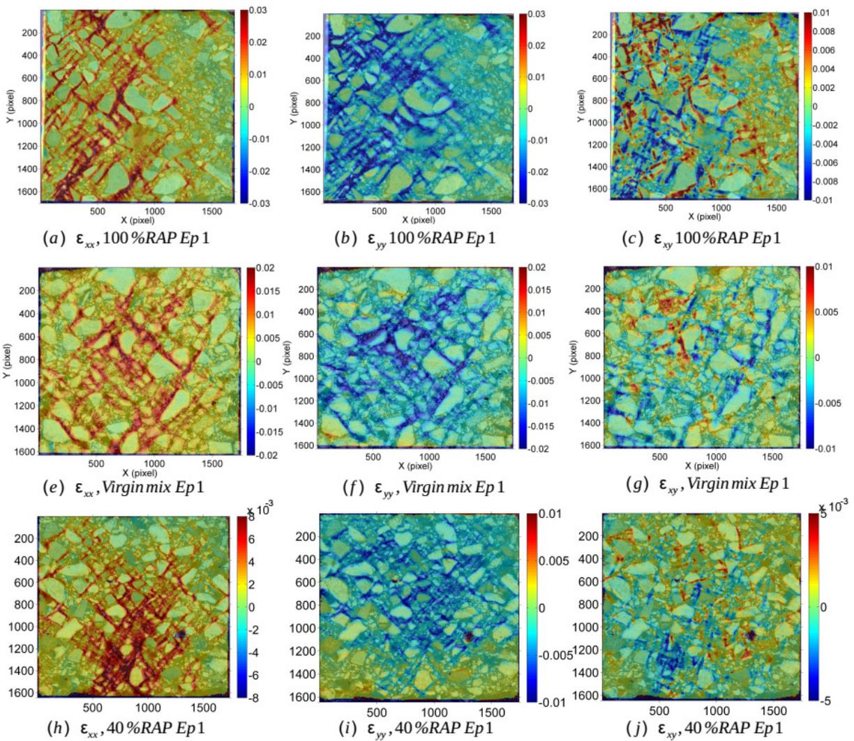
Figure 3 Champs de déformation à force maximale, pour chaque échantillon,  $\mathcal{E}_{xx}$ ,  $\mathcal{E}_{yy}$  et  $\mathcal{E}_{xy}$  sont présentées.
