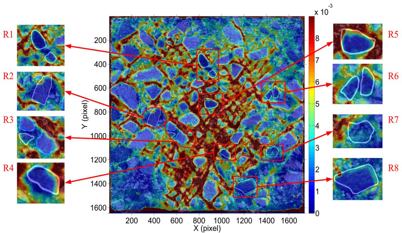
Figure 4 Déformation équivalente de von Mises sur la surface de l'échantillon 40%RAP ainsi que dans les régions R1-R8.
