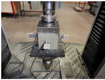
Figure 5. A gauche (Photographie du dispositif de l'essai mécanique sur la presse), à droite : Superposition des courbes contraintes en fonction de la déformation pour la formulation w/w_L=1,8 et M=20\%
