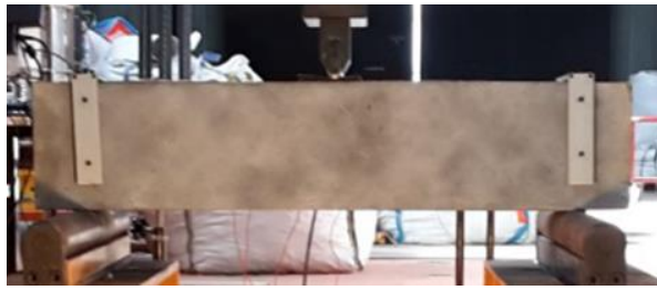
Figure 2. Dispositif d'essai flexion trois points.
