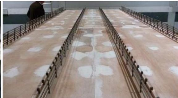
**Figure 5.** *Modèle sectionnel du tablier avec 4 écrans.*
