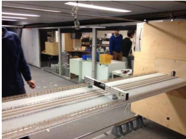
**Figure 3.** *Modèle sectionnel du tablier (1/100).*
