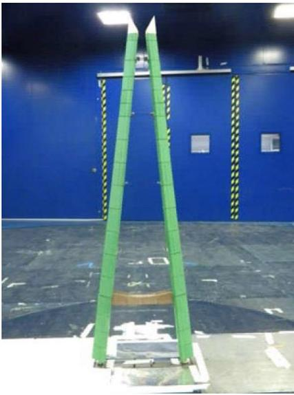
**Figure 8.** Modèle aéroélastique du pylône (1/180).
