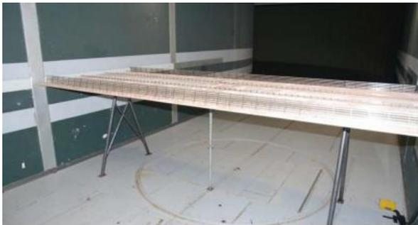
**Figure 4.** *Modèle sectionnel du tablier (1/25).*
