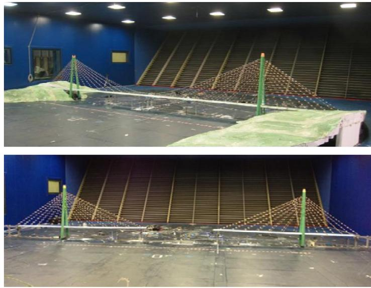
**Figure 9.** Modèles du pont complet en service (haut) et en construction (bas) (1/180).
