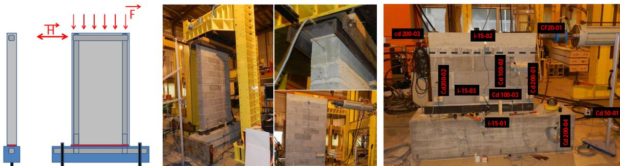
**Figure 6.** Configuration d'essais et schéma de chargement.
