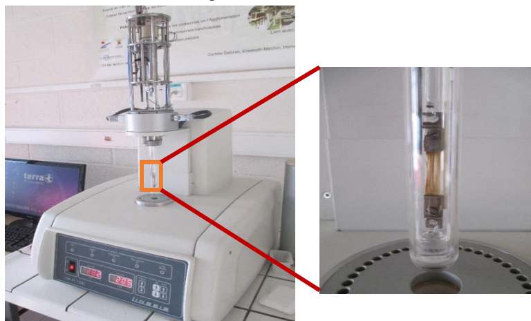
Figure 1: Analyse thermomécanique en utilisant Linseis TMA-PT1000 : essai de traction.
