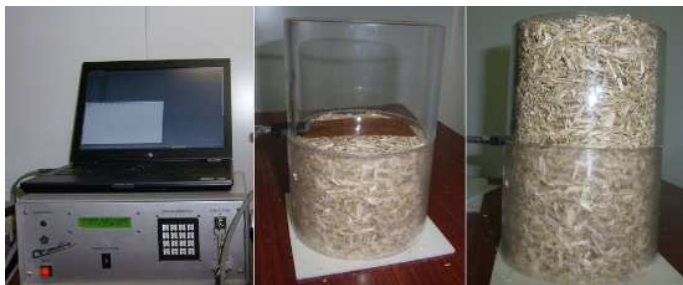
Figure 2. Mesure de conductivité thermique de chanvre en vrac avec le CT-mètre.
