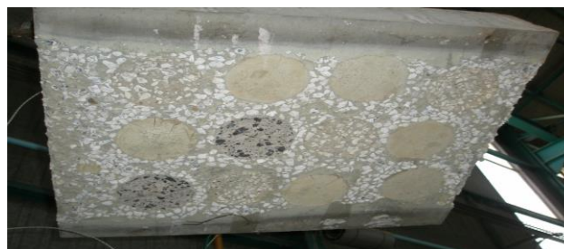
Figure 2. Sous-face de la dalle avec les différentes inclusions après refroidissement.
