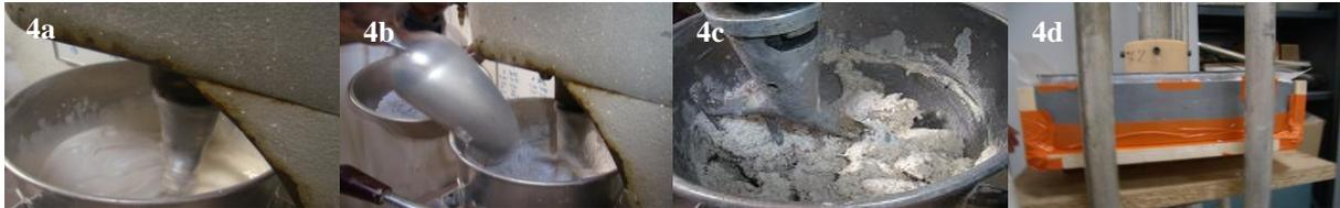
**Figure 4.** Production des composites a) malaxage du liant ; b) ajout de la charge ; c) malaxage du mélange ; d) compactage
