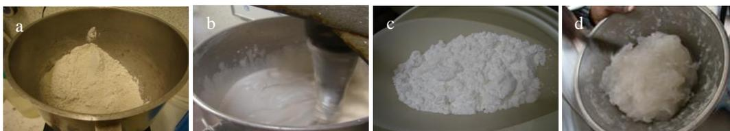
**Figure 3.** a) plâtre en poudre ; b) liant plâtre c) poudre d'amidon ; d) empois d'amidon
