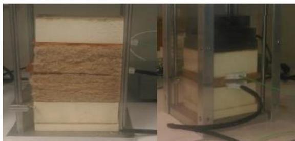
**Figure 3.** Dispositif de mesure a) de l'effusivité b) capacité thermique volumique
