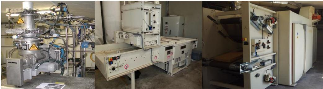
**Figure 1.** Vue de côté a) du raffineur b) de l'ouvreuse nappeuse c) du four à air chaud
