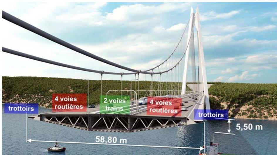
Figure 5. Disposition des voies de circulation
