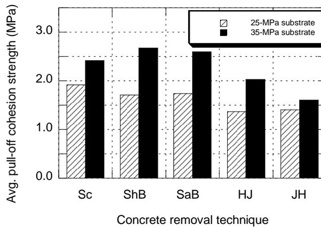
**Figure 3.** Résultats des essais d'arrachement en traction (CSA A23.2-6B modifiée) effectués sur les dalles d'essai après les opérations de préparation pour en évaluer l'intégrité mécanique superficielle.
