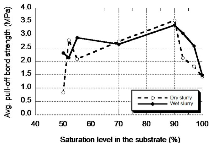
**Figure 9.** Résultats des essais d'arrachement en traction (EN 1542:1999) effectués sur des dalles d'essai réparées à différents niveaux de saturation avec un mortier de réparation modifié aux polymères, mis en place après application d'un coulis modifié aux polymères (sec ou humide).
