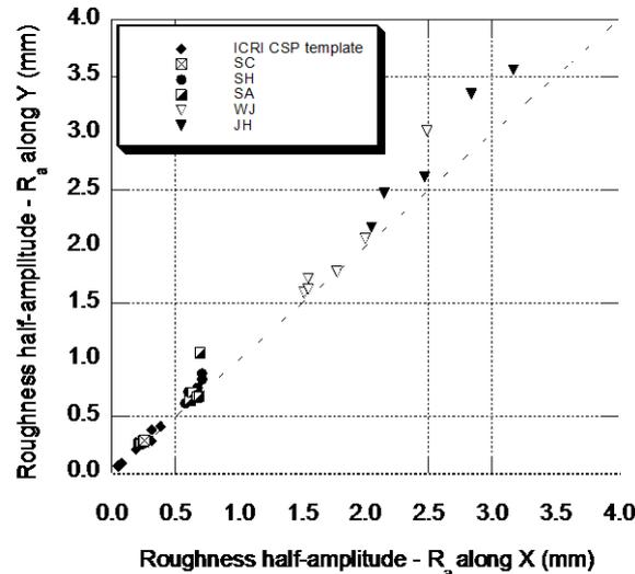
**Figure 2.** Résultats des mesures de rugosité effectuées par profilométrie optique sur des dalles de béton (25 et 35 MPa) préparées avec différentes techniques (ici et par la suite dans l'article: SC: scarification; SH: grenailage; SA: jet de sable; WJ: hydrodémolition; JH: marteau-piqueur).
