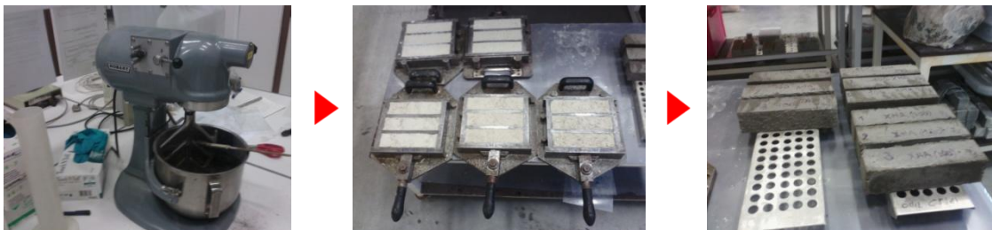
Figure 2. Etapes de la préparation de mortiers à base de CS1c et CS1-MKn (EN459-2, EN196-1)
