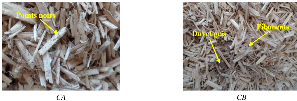
Figure 4. Observation des moisissures sur les deux types de chènevotte
