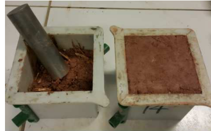
b) réalisation des échantillons cubiques
