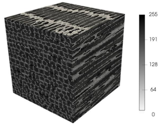
Figure 2. Volume scanné en micro-tomographie aux rayons X (400x400x400 pix 3 )
