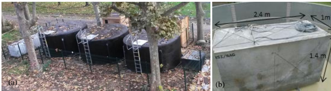
Figure 1. (a) Vue aérienne de la plateforme expérimentale dédiée aux maquettes. (b) Maquette RAG/RSI installée dans son bassin.
