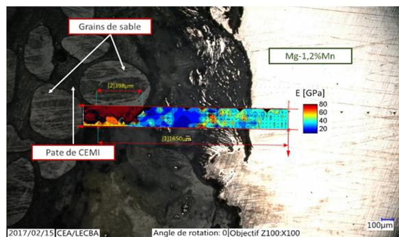
**Figure 12.** Détermination des propriétés mécaniques de la couche de produits de corrosion formés dans un CEM I au bout d'un an
