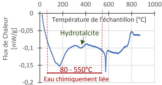
**Figure 4.** Courbes DSC d'un échantillon de mortier de laitier activé testé à 28 jours
