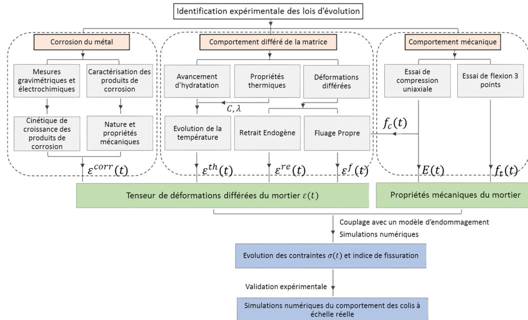
Figure 1. Représentation schématique de la méthodologie proposée
