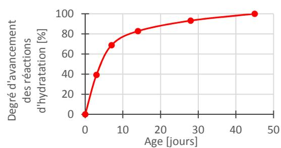
**Figure 5.** Degré d'avancement des réactions d'hydratation déterminé par ATG
