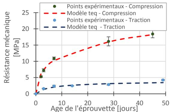
**Figure 7.** Evolution des résistances mécaniques du mortier
