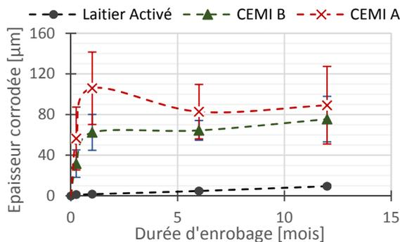
Figure 10. Evolution de l'épaisseur de métal attaqué par corrosion galvanique dans les trois mortiers
