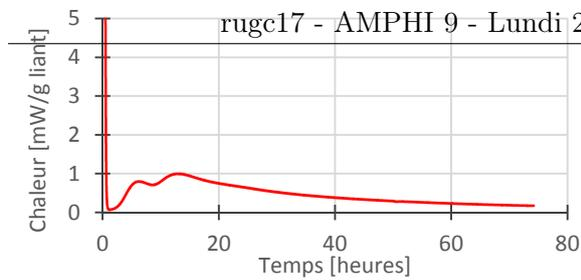
**Figure 2.** Suivi de la chaleur d'hydratation du mortier de laitier activé par calorimétrie isotherme
