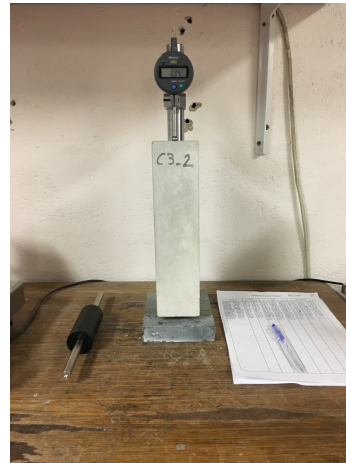
(b) Bâti de mesure de retrait
