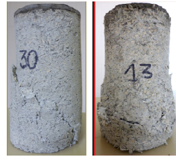
Figure 4. Modes de rupture des éprouvettes. n°30 peut être observé sur LHC-S0 et n°13 sur LHC-S0 et LHC-S20
