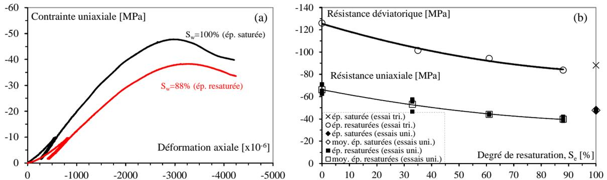
**Figure 1.** Courbe contrainte uniaxiale-déformation axiale d'une éprouvette saturée et d'une éprouvette resaturée (a), Résistance multiaxiale en fonction du degré de resaturation (b).
