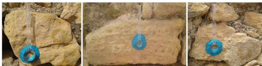
Figure 2. Exemples de calcarénites testées in situ : pierre1, pierre2 et pierre 3.
