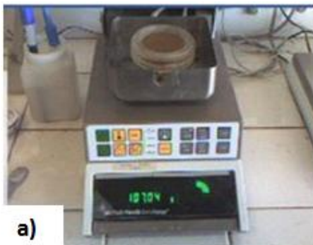
Figure 2. a) Mesure de la teneur en eau par du par pesé de l'anneau
