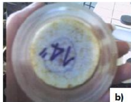
b) mesure de la succion par pesée du papier filtre
