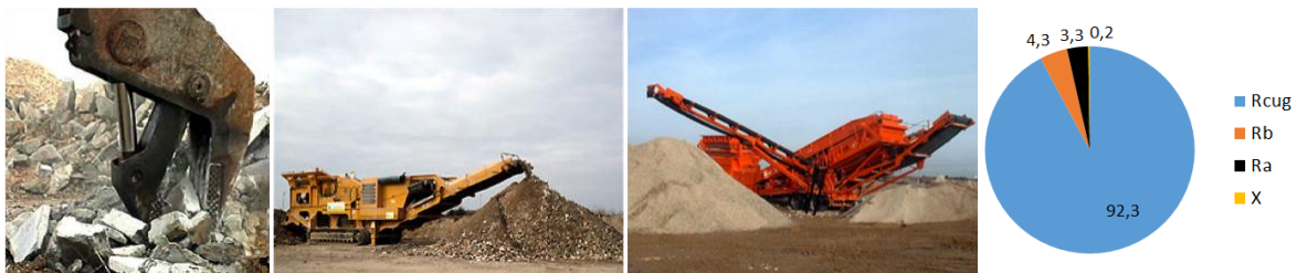
Figure 1. Process de fabrication de granulats recyclés à partir de déchets de démolition : Pince hydraulique, concasseur à mâchoire, cribleuse (illustration Planète Recyclage) ; Composition moyenne en % sur la fraction 4/31,5
