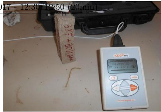
**Figure 4.** Acquisition thermique avec KD2 Pro
