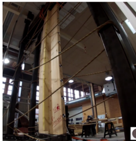
Figure 1. Dispositif d'un essai de flambement.
