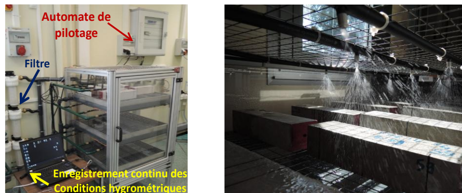
Figure 3. Le dispositif ARIEL (simulating Rainfall for concrete durability) pour corrosion accélérée par cycles de pluie en laboratoire
