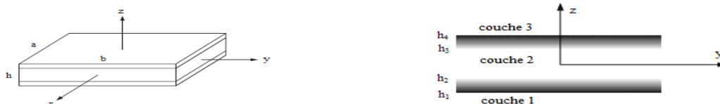
**Figure 1.** Géométrie de la plaque sandwich rectangulaire FGM.
