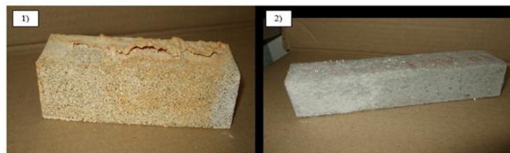
Figure 1. Éprouvettes conservées dans : 1) acide sulfurique, 2) sulfate d'ammonium.
