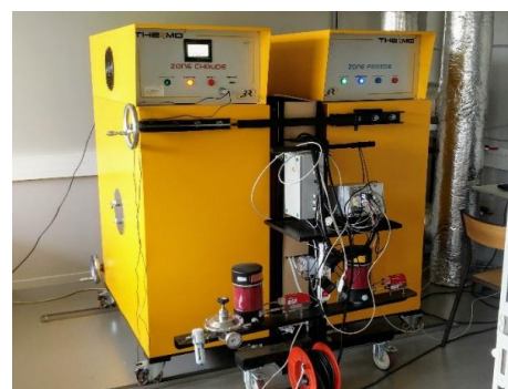
Fig.2 La cellule thermique bi climatique IUT Allier et Institut Pascal
