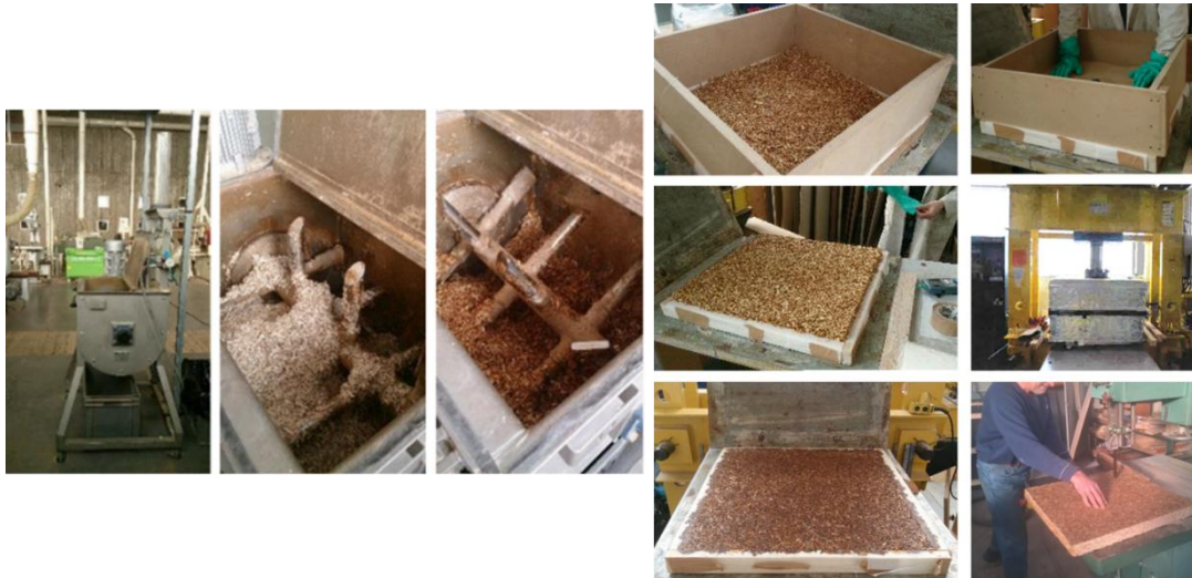
Figure 1. Illustration des étapes de fabrication du panneau rigide de chènevotte à l'aide d'un thermo-pressage de laboratoire.
