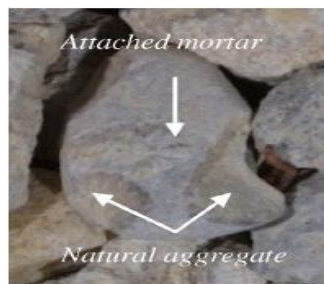
Figure.1. Compositions des granulats recyclés de béton
