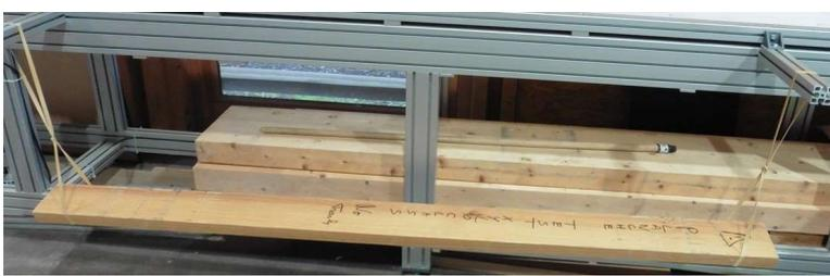
Figure 2 a: Mesures vibratoires en flexion
