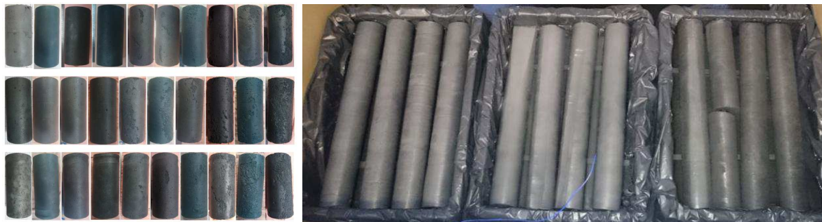
Figure 2. Gauche : Etat des éprouvettes après chaque cycle d'exposition gel-dégel (haut : eau, milieu eau gypseuse, bas : eau acide). Droite : Illustration de la conservation des carottes immergées dans les bacs placés dans les boites thermo-régulées lors d'un essai en condition isotherme.
