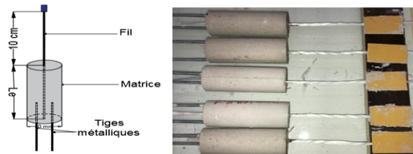
Figure 1. Eprouvettes cylindriques de l'essai d'arrachement
