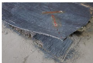
Figure 6. A) Décollement de Tissue en Fibre de Carbonne. B) Décollement du composite des dalles pré-chargées
