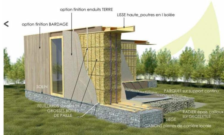
**Figure 1.** Principe de mise en œuvre d'un mur en paille porteuse (source : *Projet adream - Architecte Boha 2010*).
