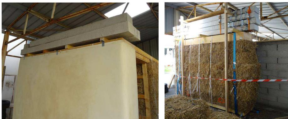
Figure 5. Chargement de murs en paille porteuse pour essai de fluage sur mur brut et enduit.
