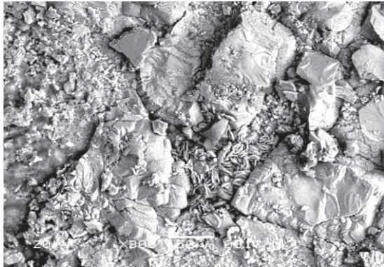
Figure 4. Produits de cicatrisation observés au MEB : Pâte de ciment avec 15% du Métakaolin et 15% du Laitier pour 4 semaines.
