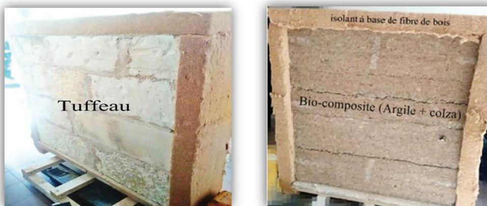
**Figure 1.** Tuffeau maçonné à la chaux isolée avec un biocomposite terre-colza.
