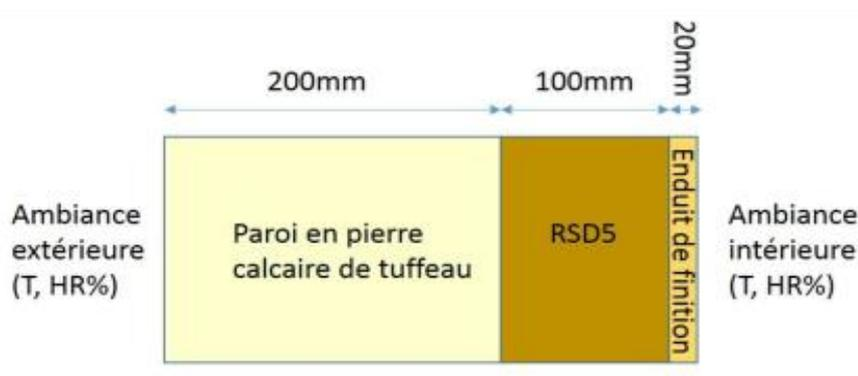
Figure 3. Modélisation de la paroi multicouche avec le logiciel WUFI et conditions aux limites.
