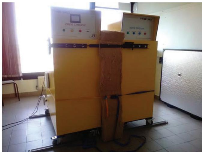
**Figure 2.** Paroi de tuffeau-terre-colza dans la chambre climatique.
