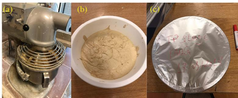
Figure 2. 1. Préparation de la boue. (a) mélanger poudre et eau, (b) boue d'argile et (c) conditionnement.
