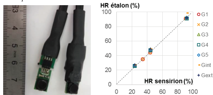
Figure 3. Gauche : Capteur SHT 35 avant et après protection de la connectique – Droite : Vérification de l'étalonnage des capteurs – résultats des capteurs de la paroi G
