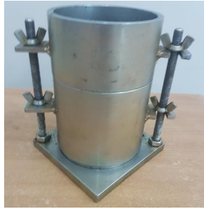
FIGURE 1. Moule cylindrique utilisé pour la fabrication des BTC
